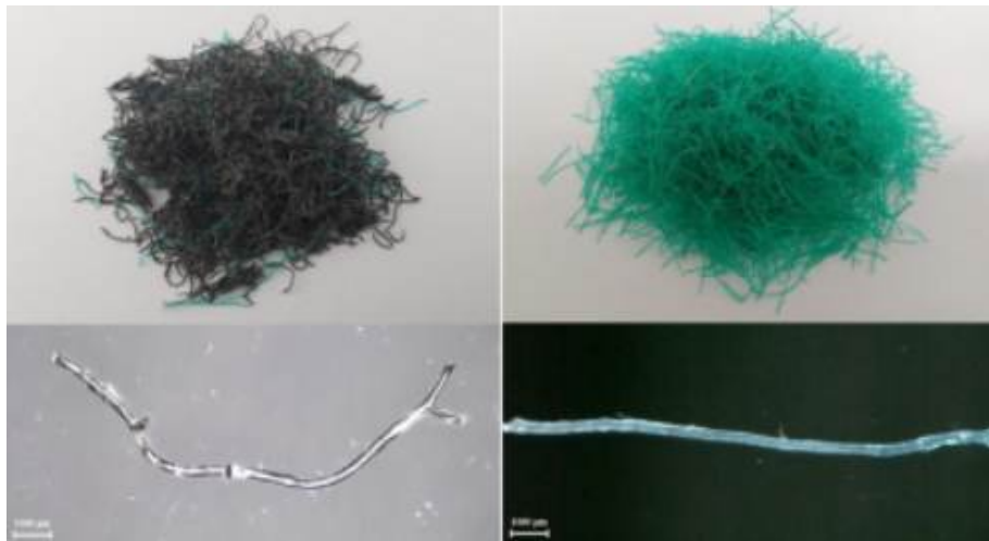
그림 1-13. 폐어망과 로프를 섬유형태로 분쇄한 모습
